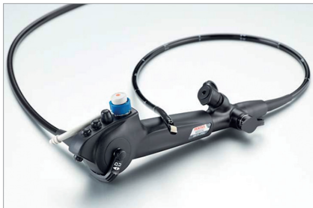
Рис. 5. Современный гибкий эхобронхоскоп высокой четкости Примечание: в дистальную часть эндоскопа вмонтирован конвексный ультразвуковой датчик (белого цвета), позволяющий «заглянуть» за стенку бронха и выполнить «зрячую» биопсию лимфоузлов и образований средостения, прилежащих к трахеобронхиальному дереву. Представлена модель Pentax EB19 J10 U ( Pentax , Япония).
